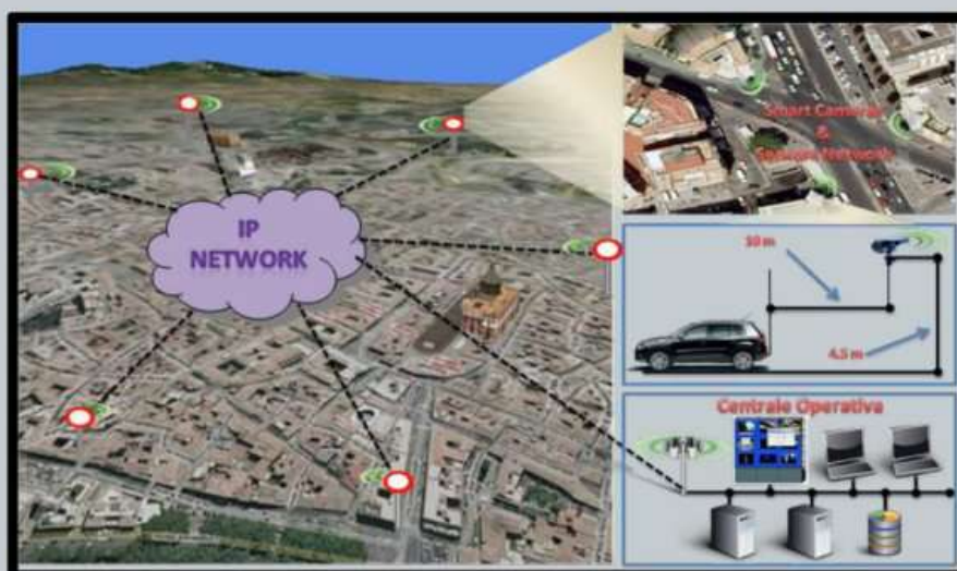
Architettura di localizzazione videocamere su base IP
